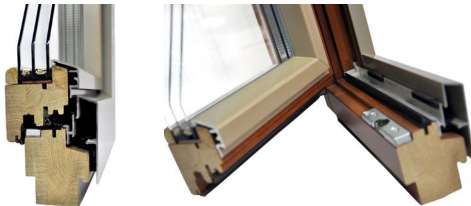
IV 68 - Holz/Alu Vertikalschnitt RSB 25mm Dichtung: 16,5mm Verglasung: Nassverglasung
