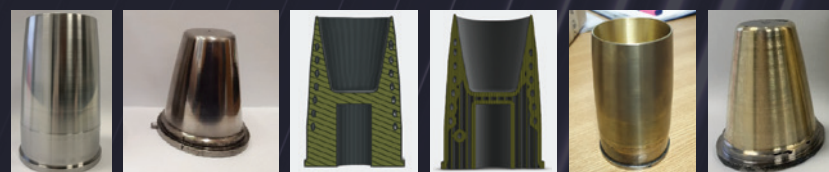
3D tiskana orodna vložka iz prahu jekla maraging
