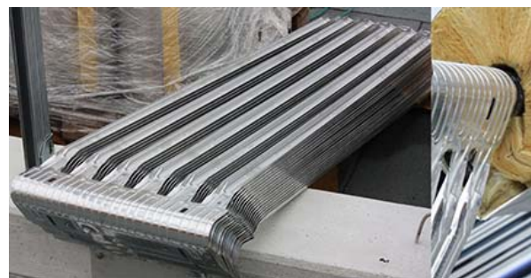
Slika 5: Patentirani aluminijasti paneli (proizvajalec Talum) pred montažo. Na šestih uparjalnih rebrih, povezanih s kondenzatorskim delom, je vidna mreža 'toplotnih cevk'. Na detajlu (desno) je prikazana namestitev na zbirno cev ob montaži.
