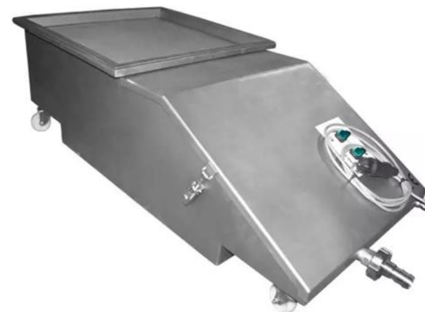
Črpalka za filtracijo in transport jabolčne kaše (vir: e-shop.czechminibreweries.com ).
