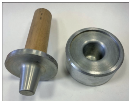
Slika 2: Pozitiv in negativ kalupa osnovnega vzorca / Figure 2: Positive and negative of the basic pattern mould
