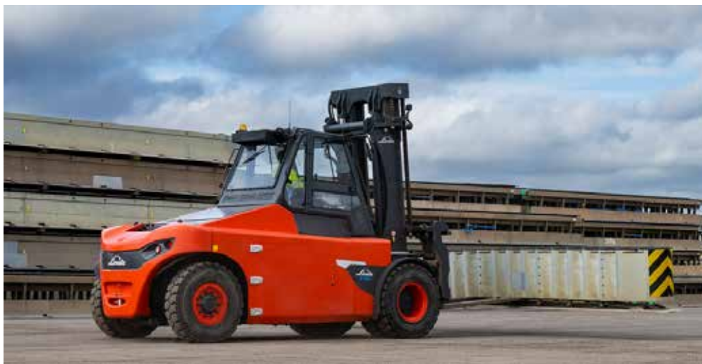
Podjetje Linde je predstavilo njihov največji električni viličar Linde E100-E180, z nosilnostjo od 10 do 18 ton.
