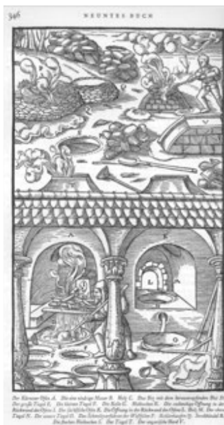
Koroška peč, De Re Metallica, 9. knjiga, str. 346.
