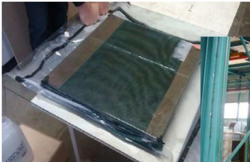
Posnetek pri pripravi izdelka - plošče z vakuumsko infuzijo.
