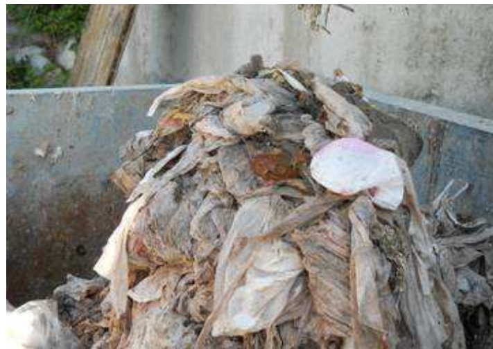
Priprava na vzorčenje - Ostanki na grabljah (foto: B. Justin)
