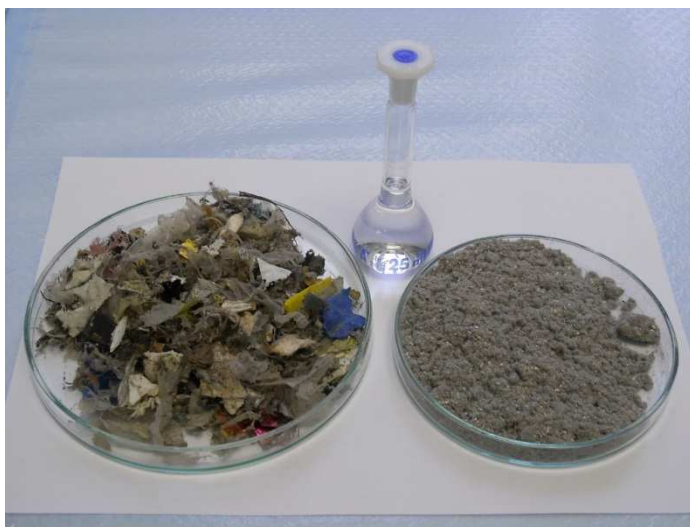
Priprava vzorca odpadka za določevanje vsebnosti kovin (foto: V. Rožič)
