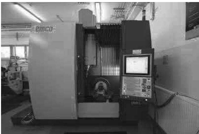
Nova pridobitev škofjeloškega centra je s sodobnimi tehnologijami opremljen laboratorij. Na sliki petosni CNC obdelovalni stroj za simultano obdelavo kovin
