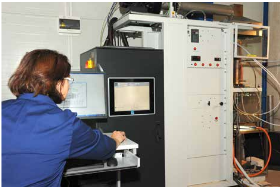
Konusni kalorimeter s FTIR analizatorjem dimnih plinov
