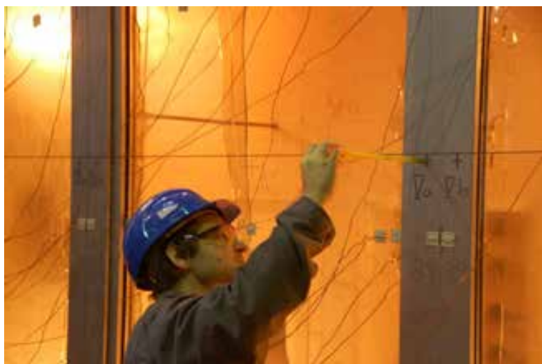
Preskušanje požarne odpornosti zastekljene stene na vertikalni peči
