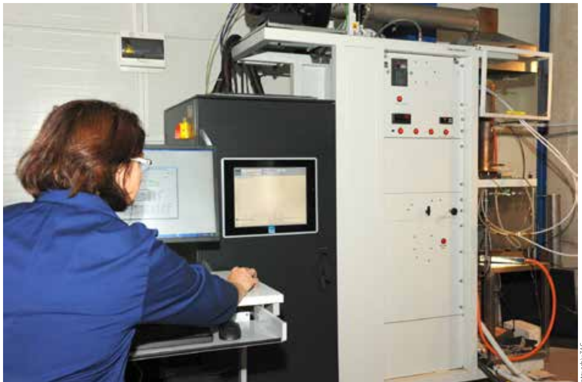
Konusni kalorimeter s FTIR analizatorjem dimnih plinov
