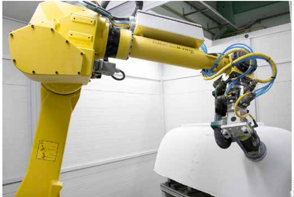
Robotsko brušenje kerrock kopalne kadi.
