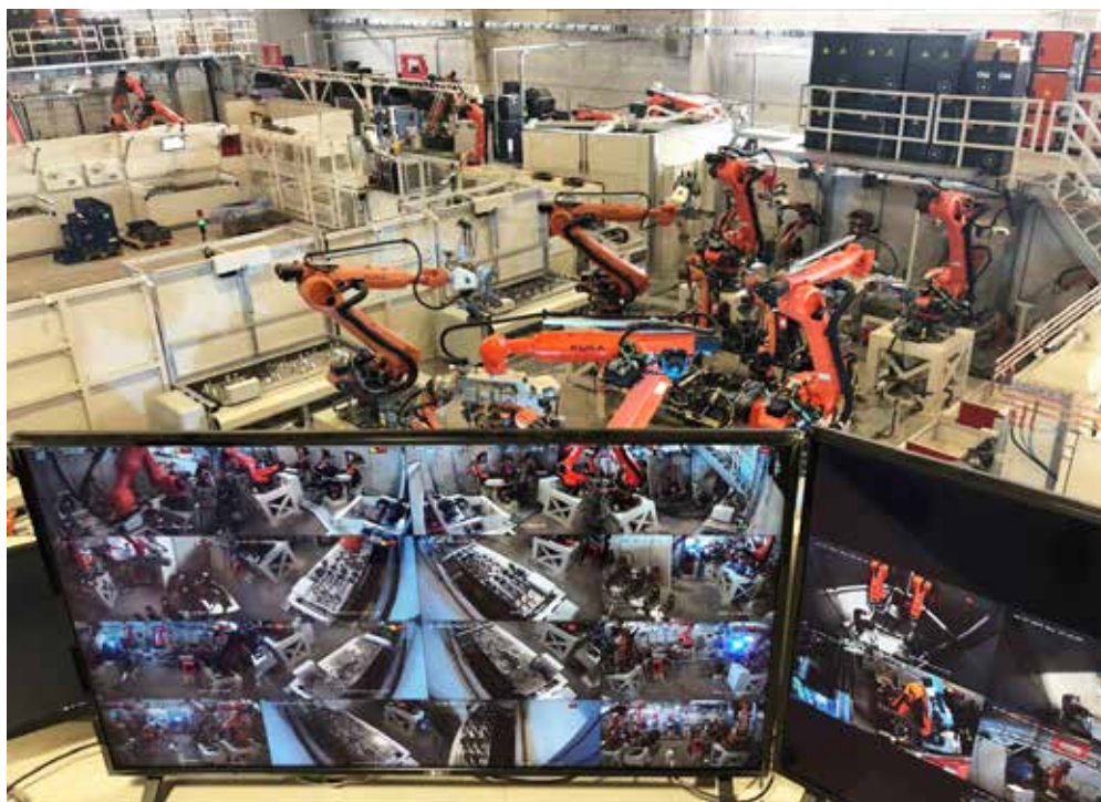
TPV AUTOMOTIVE – povsem robotizirana linija varjenja ultralahkih jeklenih komponent.
