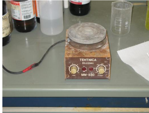
Slika št. 9: Poškodba vodnika (kabela) magnetnega mešala
