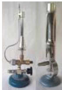
Slika št. 23: Bunsenov gorilnik, opremljen s termičnim varovalom.
