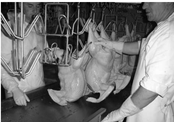
Obešanje puranov na nova obešala. V ospredju detalj obešala, ki omogoča obešanje različnih vrst perutnine.
