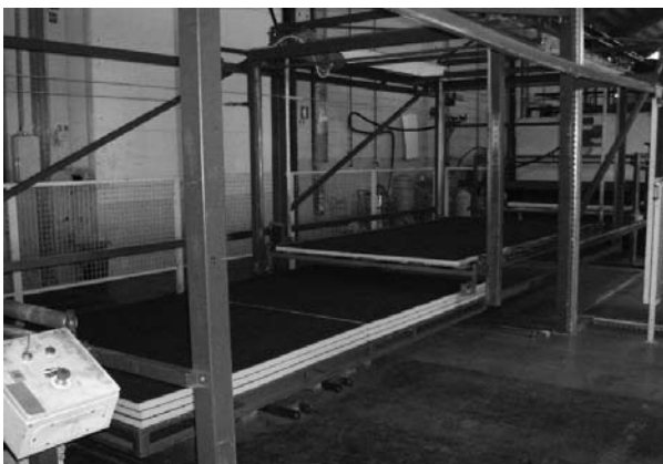
Avtomatsko zlaganje troslojnih plošč na palete
