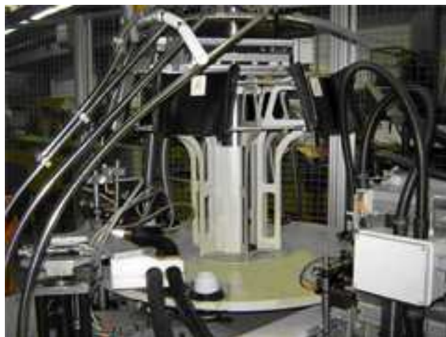
Lepilna naprava za proizvodnjo gibljive cevi
