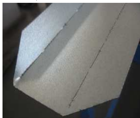
Laserska perforacija pločevine in zvita pločevina
