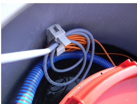
3. Priklop kabla na krmilje je možen samo na en način, saj je na vtiču poseben utor. Krmilje ima cca 1,2 m električnega priključnega kabla, zato pazite na razdaljo do električne vtičnice (230V).
